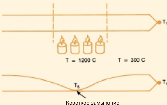
Рис. 18. Локальный нагрев термопары и изменение сопротивления
