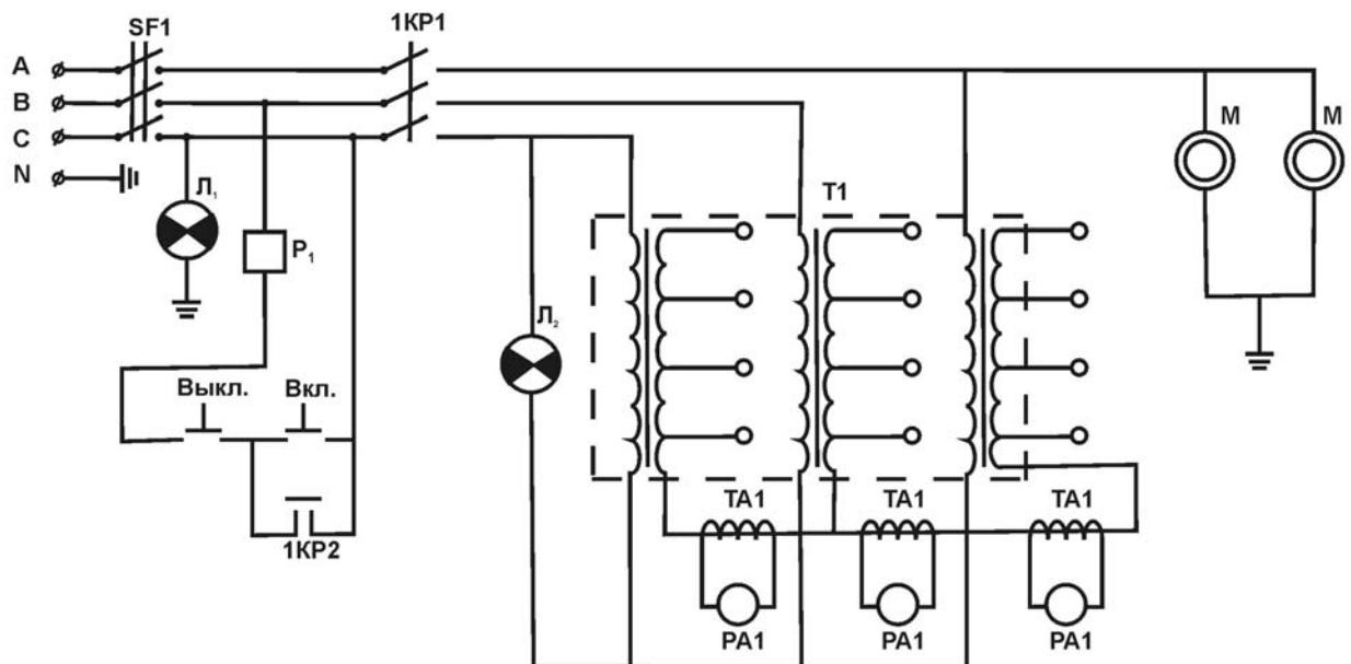
рис 2. Схема электрическая принципиальная.
